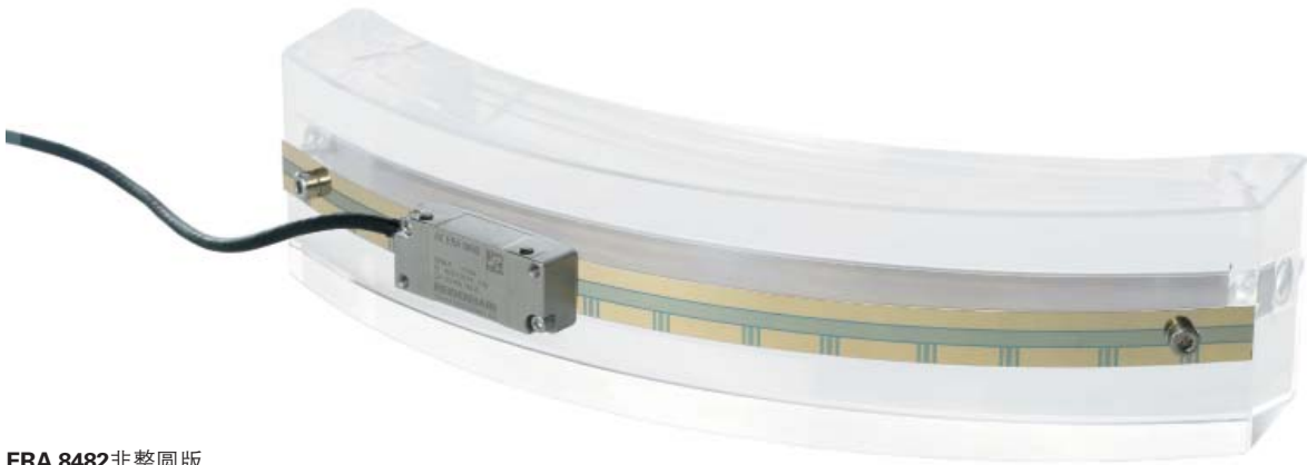
ERA 8482 非整圆版， 钢带光栅尺无张紧元件
